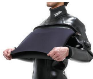
防水ファスナーは使用していません。開口部をしめ具で縛って、胸部に収納、1人で着脱が可能です。開口部内側のスキン素材がOリングの働きをすることで浸水を防ぎ、開口部のある胸部は、スーツ内外及びスーツ上下の微妙な圧力差によって浸水を防ぐ構造です。40年以上ご愛顧いただいています。(株) ゼロが特許取得した定番商品です。
