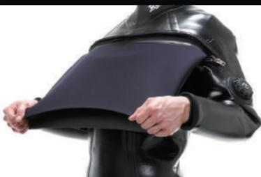
防水ファスナーは使用していません。開口部をしめ具で縛って、胸部に収納、1人で着脱が可能です。開口部内側のスキム素材が0リングの働きをすることで浸水を防ぎ、開口部のある胸部は、スーツ内外及びスーツ上下の微妙な圧力差によって浸水を防ぐ構造です。40年以上ご愛顧いただいています。(株)ゼロが特許取得した定番商品です。
