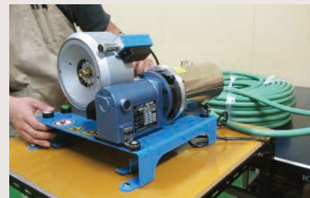
加締め作業写真
