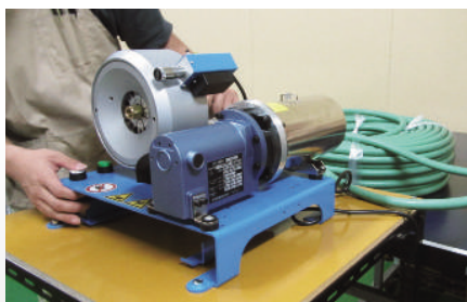
加締め作業写真
