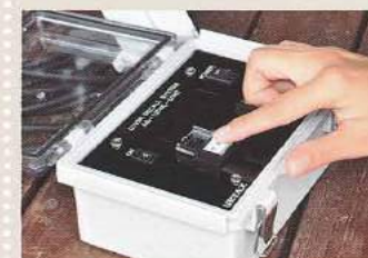
陸上で使用するコントローラー。発信スイッチをONにするだけで水上の警報システムに信号が送られる。
