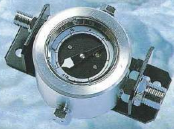
流量計 高気圧障害防止規制第9条に基づき、ヘル メット、マスクなどのダイバーの安全のために設計 されました。バイパス型で、垂直以外でも正確な 値を示します。 ●耐圧15kg/cm 2 ●最高使用圧力10kg/cm 2 ●計測流量30~300/分●配管径M14×1.5 NO.823000 ¥56,000
