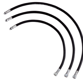
中圧ホース (レギュレーター用) ■50cm 本体価格 ¥6,000 ■60cm 本体価格 ¥6,000 ■70cm 本体価格 ¥7,000 ■ホース部ラバー仕様 ■ネジ1st側3/8-24UNF(♂) 2nd側9/16-18UNF(♀)
