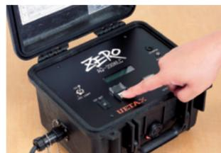
陸上で使用するコントロールローラー。発信スイッチをONにするだけで水上の警報システムに信号が送られる。
