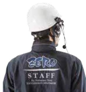
SV-230TRIに付属しているトランスシーバーにインカムを取付け、本体(アンプ)から離れた陸上作業員と水中にいるダイバー間で会話することができます。
