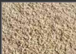
製鉄原料として売却された焼却灰は製鉄会社の製鉄プロセスを通りセメント原料・土木資材（スラグ）へと生まれ変わります。
