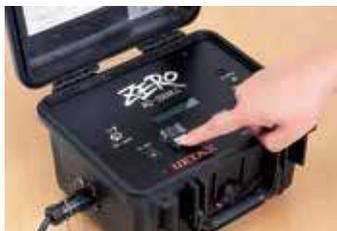
陸上で使用するコントローラー。発信スイッチをONにするだけで水上の警報システムに信号が送られる。
