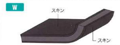
W 【表】スキン 【裏】スキン 【生地厚】5.0mm、6.5mm 【カラー】ブラック ●使用モデル: ウェットスーツ/PW-8200
