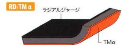
RD/TMα 【表】ラジアルジャージ 【裏】サーモマジックアルファ 【生地厚】3.5mm、5.0mm、6.5mm 【カラー】ブラック ●使用モデル: ドライスーツ/K'sプロII TRD、 流水プロIII TRD、O式プロII TRD
