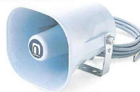
□小型船舶無線機用 小型ホーンスピーカー (防水・耐塩) NP-108 ●ASA耐候性樹脂製ホーン、ネジ類・取付金具はステンレス製、コード5m付 入力: 5W 寸法: 口径154×140mm、全長155mm インピーダンス: 8Ω/質量: 約1.0kg オープンブライズ
