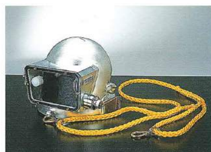
デスコエアハット 船上より送気して潜水するヘルメットで、首部のネックシールでヘルメット内への水の侵入をふせぎます。排気は解放式なので楽に潜水できます。オプションにて排気弁を二重にし、首部にデスコ用ヨークを取付けたドライスーツで、原子力潜水、汚染海域潜水にも使用することができます。 (O式タイプ、流氷タイプのプロドライスーツのネック部を改良して使用可能です。¥12,000) 標準小売価格 オープンプライス
