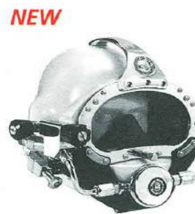
カービー・モーガン スーパーライト27Bヘルメット 浅海潜水・深海潜水混合ガス用開方式ヘルメット。ヘルメット本体はハンドレイアップ加工でファイバークラス・カーボンファイバーにて補強された構造になっています。口鼻マスクはシリコン製。通信システムはマイク、イヤホン。取替簡単モジュラー方式です。ヘルメット本体及びヨーク取付はラッチシステム構造です。 標準小売価格 オープンプライス
