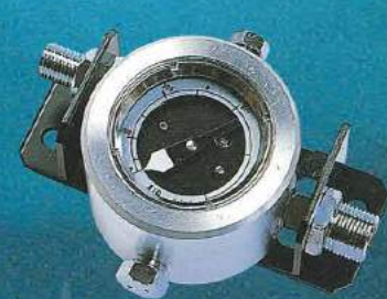
流量計 高気圧障害防止規制第9条に基づき、ヘル メット、マスクなどのダイバーの安全のために設計 されました。バイパス型で、垂直以外でも正確な 値を示します。 ●耐圧15kg/cm 2 ●最高使用圧力10kg/cm 2 ●計測流量30〜300ℓ/分 ●配管径M14×1.5 NO.823000 ¥56,000
